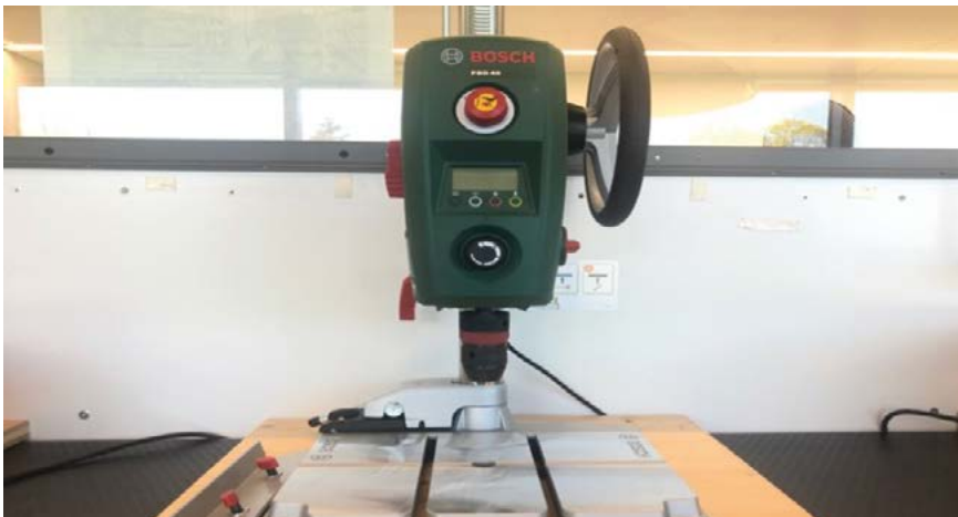
BOHRMASCHINE MIT DREHZAHLEREGULIERUNG
