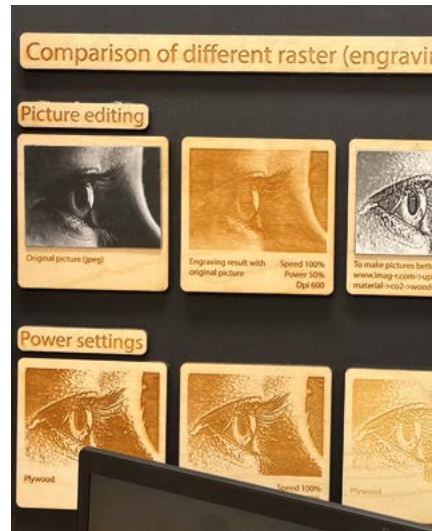
3D-DRUCK UND LASER-EINSTELLUNGEN SIND ANHAND VON BEISPIELEN ERSICHTLICH (UNIVERSITÄT TAMPERE, FINNLAND)
