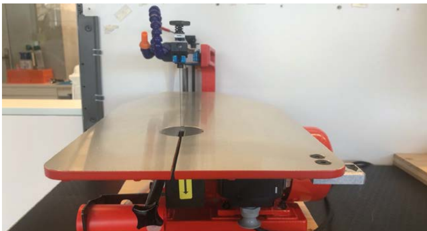
DEKUPIERSÄGE MIT ALLZWECKSÄGEBLATT
