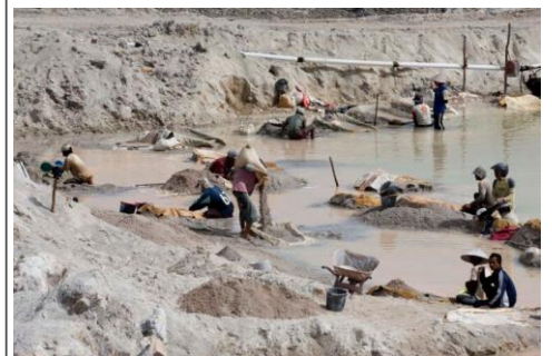
(Zinnabbau auf der Insel Bangka-Belitung, Indonesien. Aus tiefen Gruben pumpen die Menschen die zinnhaltige Erde aus dem Boden. Immer wieder brechen Gruben ein und gefährden die Arbeiter)
